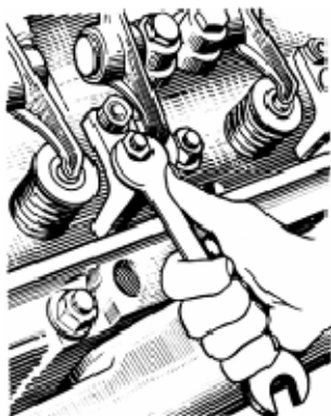
Рис. 74.Отвертывание гайки скобы крепления форсунки
