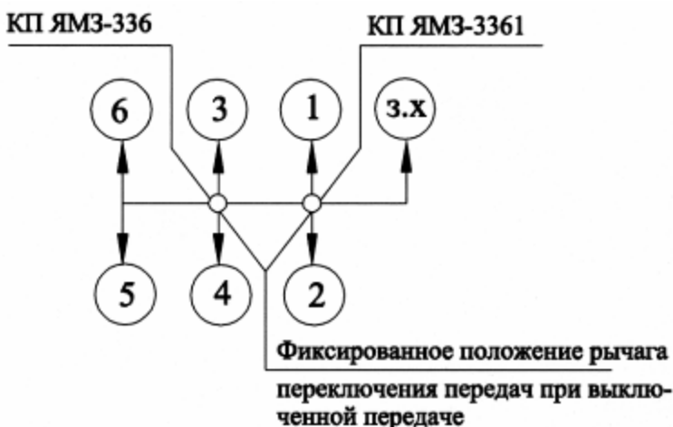
Рис. 111. Схема переключения передач КП.
