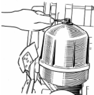
Рис. 55. Отвертывание гайки колпака
