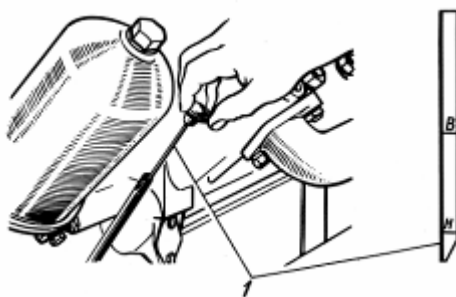
Рис. 52. Проверка уровня масла в поддоне двигателя: 1—указатель уровня масла.
